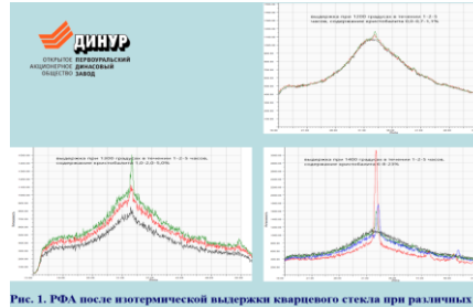
Рис. 1. РФА после изотермической выдержки кварцевого стекла при различных температурах в течении 1-2-5 часов
